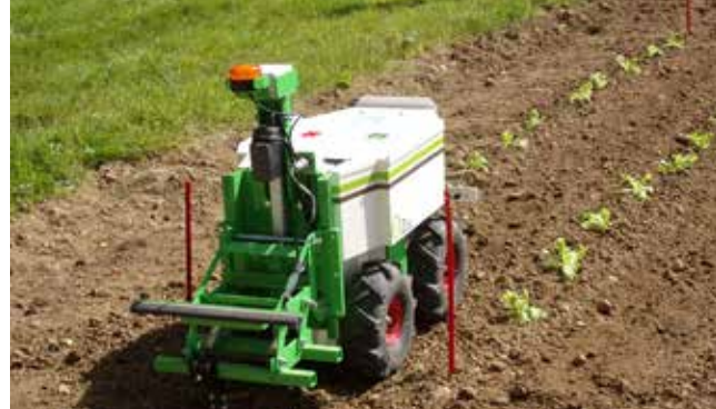
Le robot Oz en action entre des rangs de salades (photo DRIA AF-SRAL)
