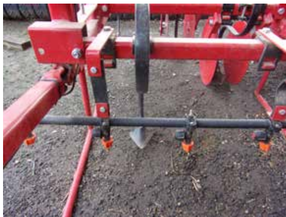
vue de la rampe de pulvérisation à l'avant de la bineuse (photo DRIAAF-SRAL)
