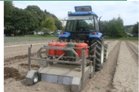
Exemple de désherbeur thermique (GRAB PACA)
