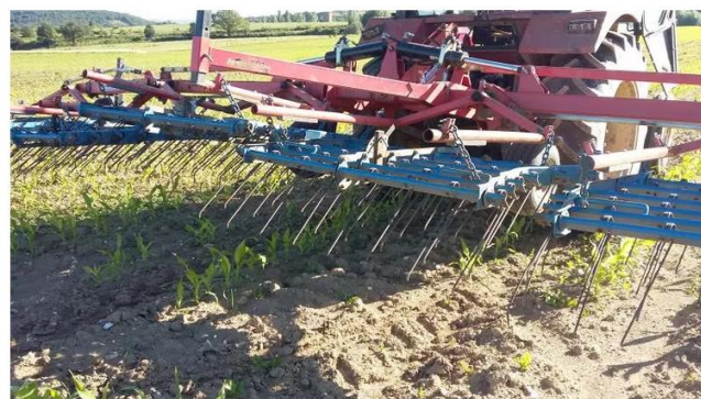
La herse étrille en plein travail de désherbage sur maïs. © © Chambre d'agriculture
