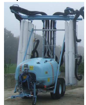
S21 – Tunnel de pulvérisation
