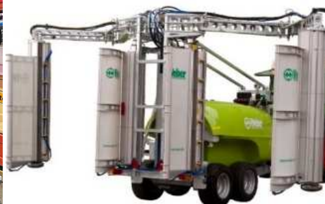
WEBER – descentes avec panneaux récupérateurs
