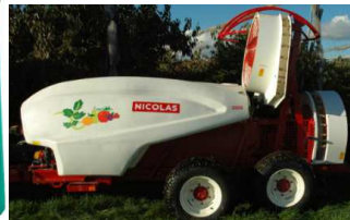
S21 – Double turbine vergers voûte droite
